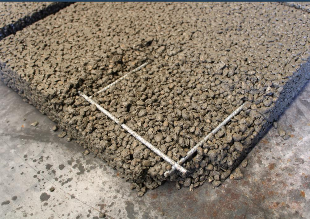
L'utilisation d'armature en acier galvanisé dans les produits et structures en béton présente de nombreux avantages. Dans les environnements agressifs, la nécessité d'augmenter l'enrobage du béton peut être évitée. Dans des conceptions en béton plus léger et plus mince, l'armature en acier galvanisé protège contre la carbonatation lorsque l'enrobage du béton a été réduit.
