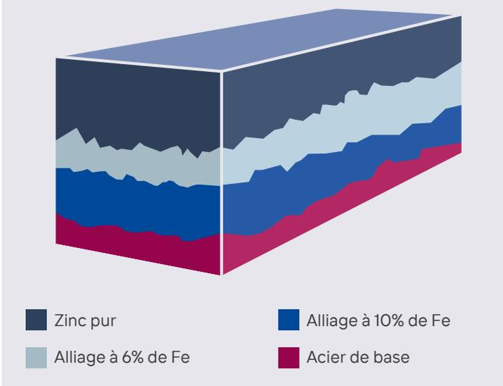
à 12,5. Dans cette plage, une couche protectrice se forme à la surface du zinc, de sorte que la vitesse de corrosion est très faible. La résistance thermique est également excellente. Les structures en acier galvanisé à chaud, comme les remontées mécaniques, dans les régions alpines et dans les stations de recherche de l'Antarctique, sont des exemples de performances extrêmes à basse température.
